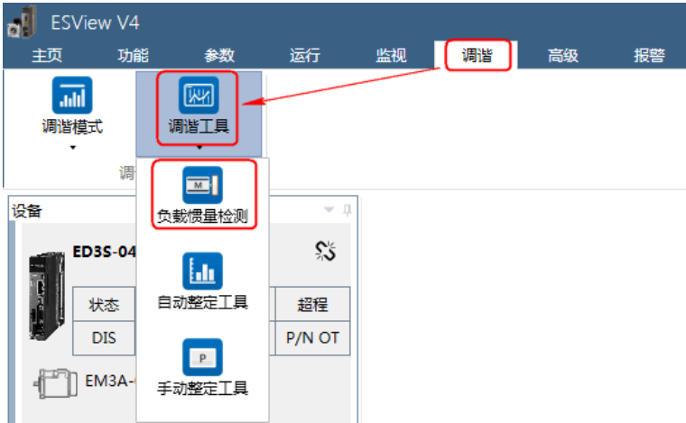
图9-35 选择负载惯量检测
